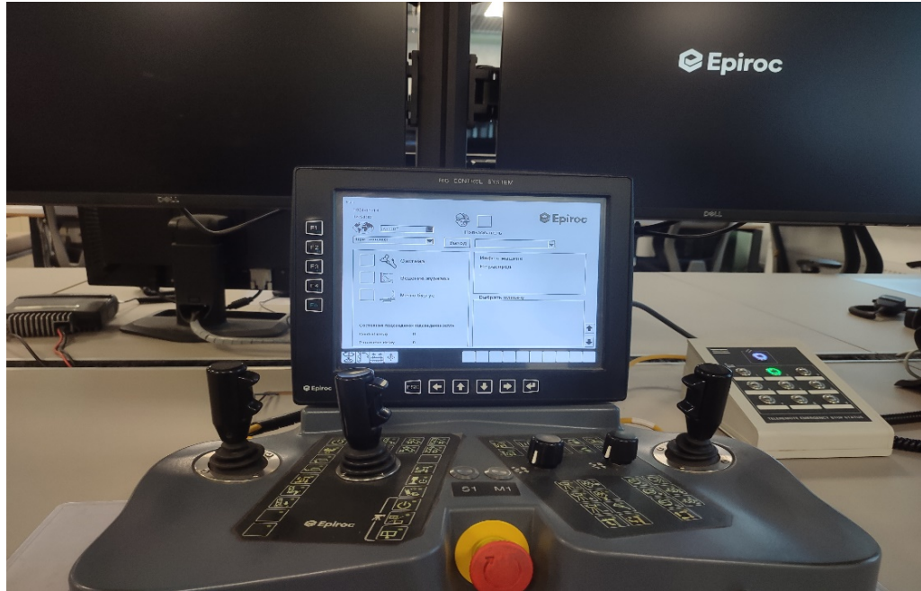
Рис. 4.6. Загальний вид панелі оператора віддаленого управління буровими верстатами
