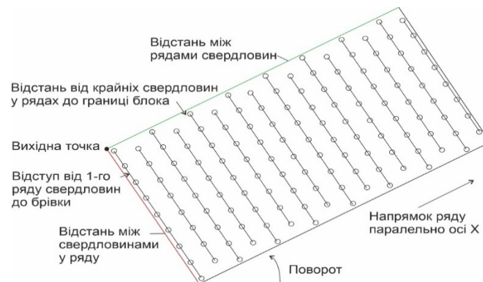
Рис. 4.28. Параметри схеми буропідливних свердловин
