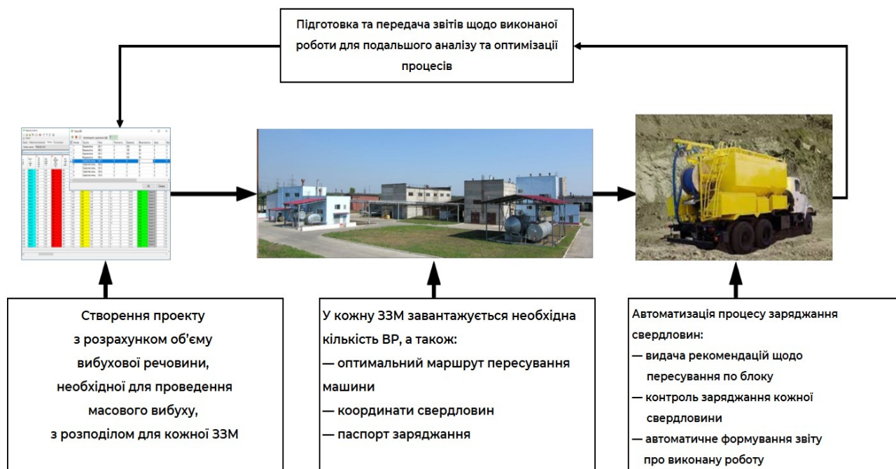
Рис. 4.21. Структура процесу обміну даними зі змішувально-зарядними машинами
